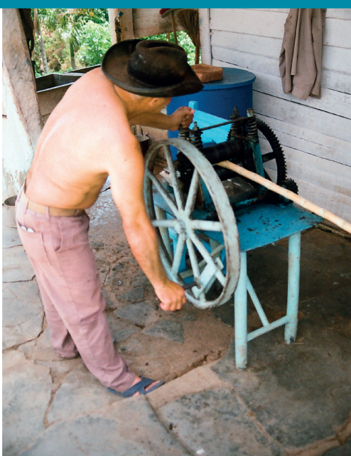
Viñales. Maszyna do produkcji soku z trzciny cukrowej — guarapero.
